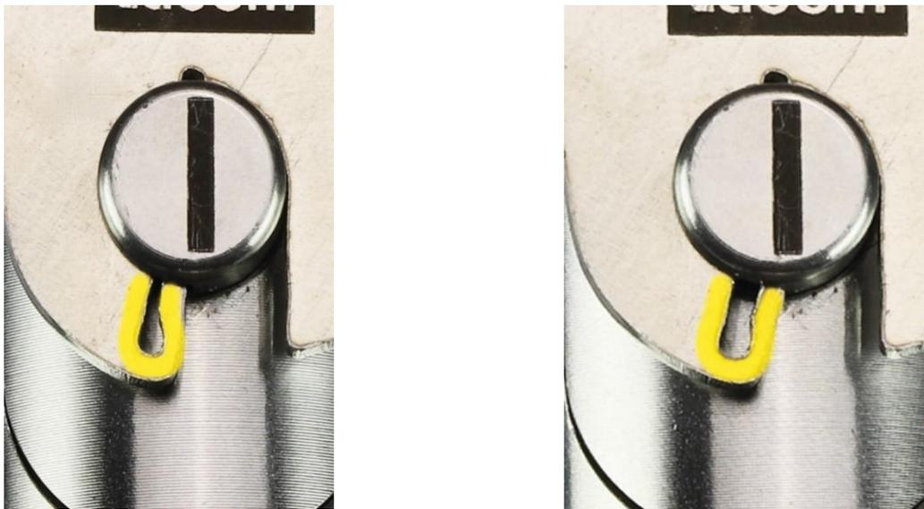
Abbildung 10: Ansicht vor und nach Verbiegen der Federlasche (entscheidender Bereich gelb hervorgehoben)
